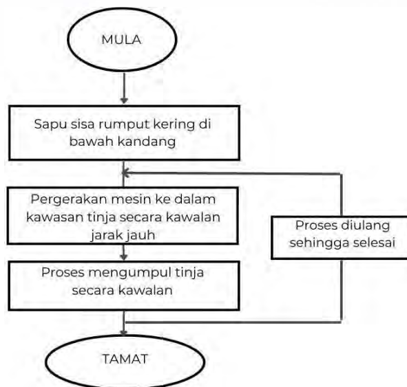
Rajah 9. Carta Alir Proses Kerja Pengumpulan Tinja Menggunakan Mesin Pengumpul Tinja Kambing
