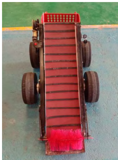
Rajah 7. Pandangan hadapan Mesin Pengumpul Tinja Kambing
