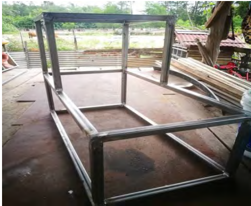
Rajah 3(c): Rangka awal mesin
